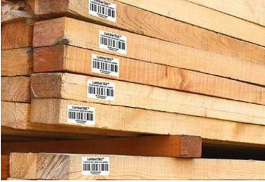
Figura 20. Esempio di codici a barre applicati ad assi di legno
